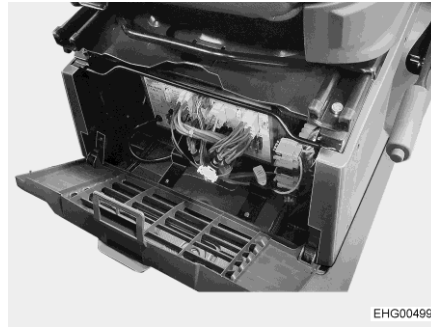
Kuva 94 Asennuspaikka, sähkö- ja elektroniikkayksikkö
