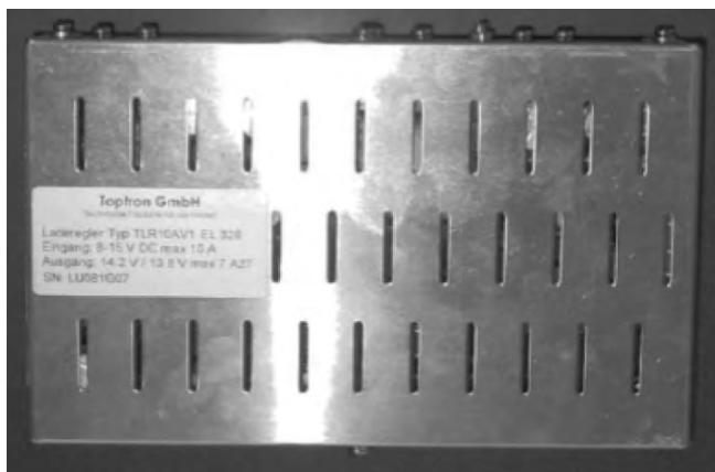
Latauksensäädin seinällä olevassa vaatekaapissa
